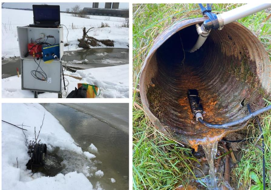
Figure 2.2 : Sonde ISCO à la sortie d'un drain et station d'alimentation en énergie dans Pot-au-Beurre
