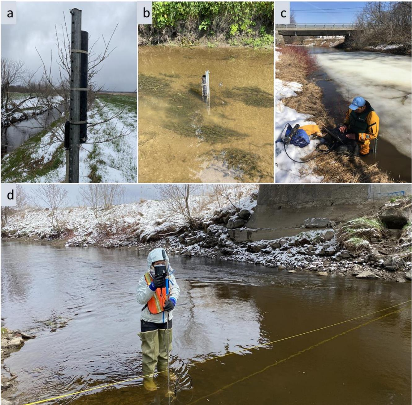
**Figure 2.4 : Installation et entretien des stations hydrologiques dans le bassin versant de la rivière Saint-Germain. a) sonde à pression-b) sonde multi-paramétrique YSI, c) entretien de la sonde YSI, et d) opération de jaugeage.**
